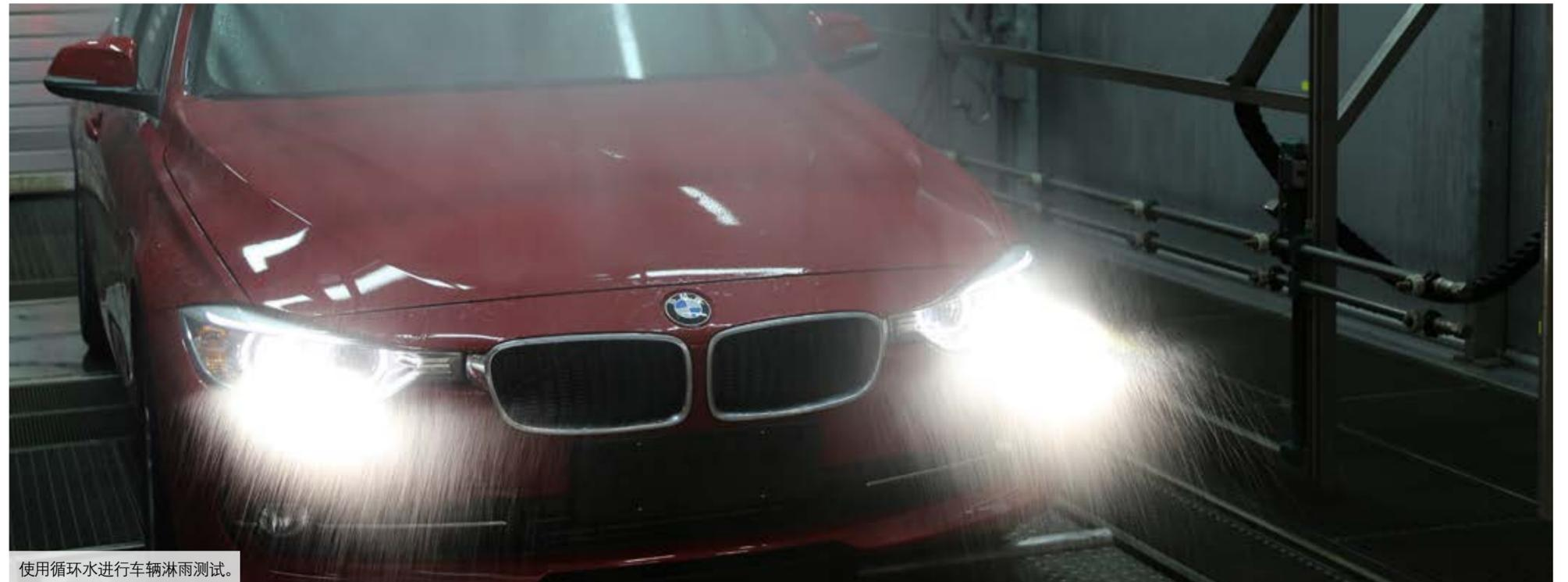
使用循环水进行车辆淋雨测试。
