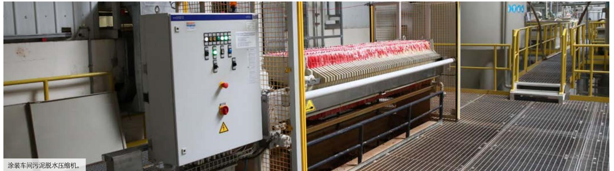
涂装车间污泥脱水压缩机。
